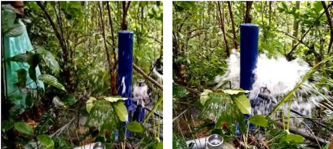
Gambar 7. Uji performa desain pompa hidram III
